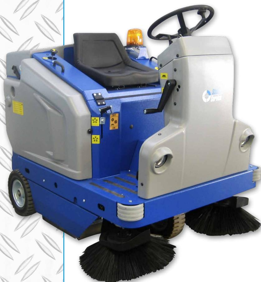
Die Stefix 108 ist eine robuste Kehrsaugmaschine mit einer Arbeitsbreite von 1.300 mm. Die Maschine ist mit dem 6 m<sup>2</sup> großen Staubfilter besonders zum Kehren von sowohl groben Schmutz und feinem Staub geeignet. Dank des hydraulischen Antriebs am Vorderrad und der einfachen Bedienung kann eine Leistung von 9.000 m<sup>2</sup> zu reinigende Oberfläche pro Stunde erreicht werden.
